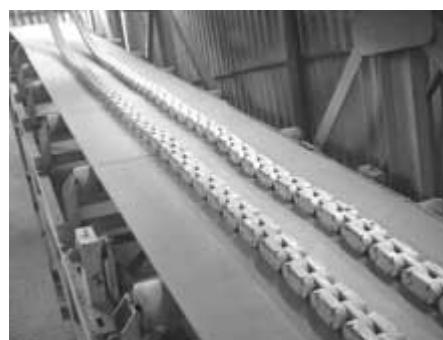
图 3 在皮带上方正在进行检定的两条标准质量循环链码
