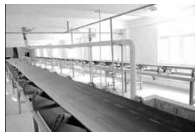
图 6 QPS 皮带秤全性能测试系统的局部
