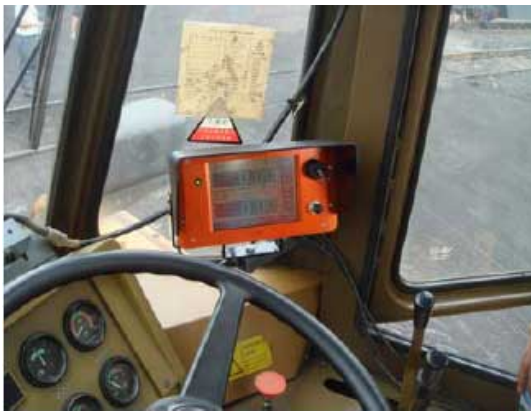
图 2 车辆组合式衡器—装载机电子秤
