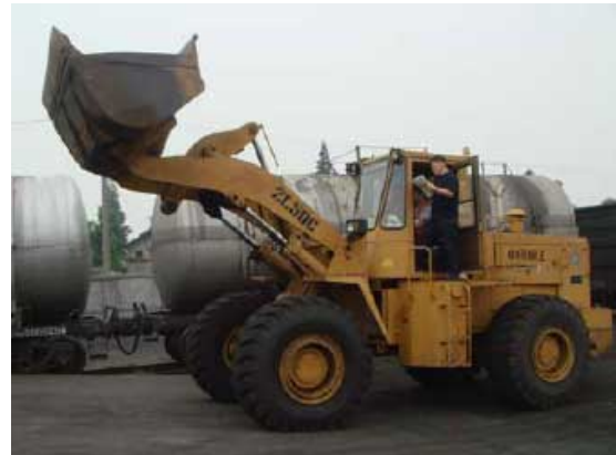
图 2 车辆组合式衡器—装载机电子秤
