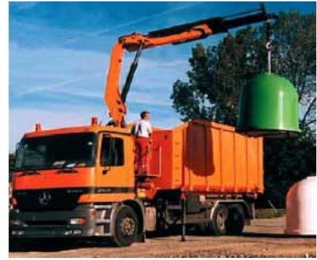
图1 车载式衡器—随车吊电子秤
