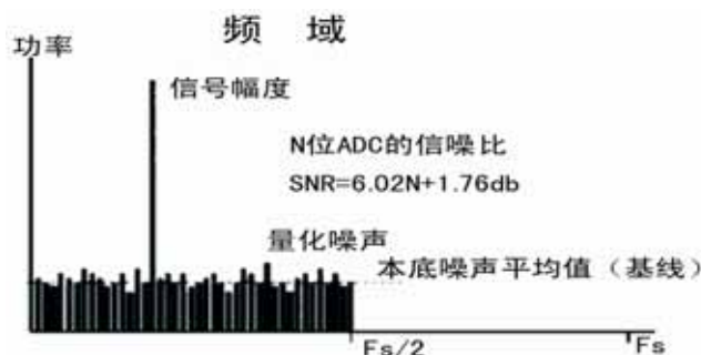
图 1 N 位 ADC 以频率 f_s 采样单音信号的频谱分析
