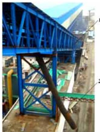
图 5 卸料犁下方安装的卸料管
