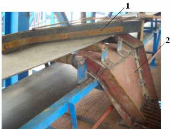
图 4 皮带秤后面安装的卸料犁
