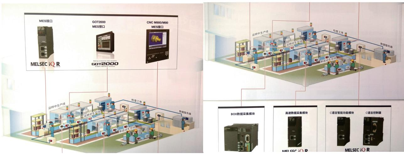
生产设备和 MES 信息协同接口不通过专用数据采集装置，直接收集测量数据高速数据采集模块；能够在现有设备运转状态下直接加装网络，收集数据的 BOX 数据记录器；能够通过 C/C++ 语言程序实现控制、信息处理、上层通信处理的语言控制器；从上层信息系统到设备管理系统，FA-IT 信息协同产品系列实现工厂智能化管理。
