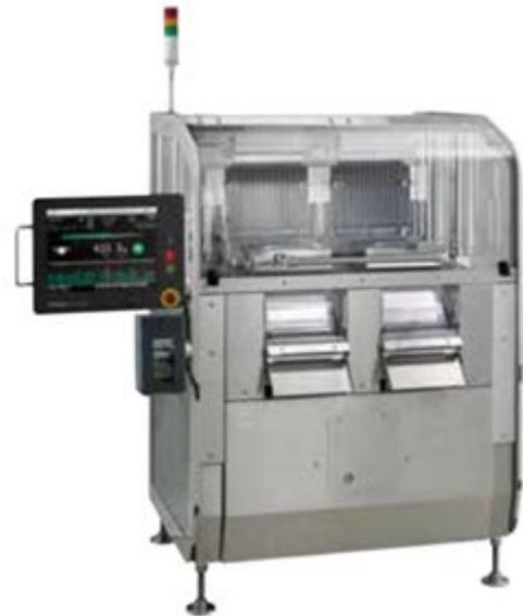
图 1 KWS9001AP 胶囊检重秤的外观图
