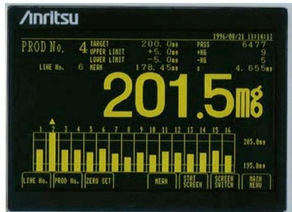
图 3 胶囊检重秤的显示画面
