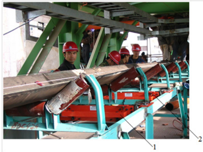
图 3 由两台 MSI 单托辊秤架组成的 MMI 多托辊皮带秤秤架
