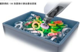
图 25 基恩士配置 3D 视觉传感器三维机械手视觉系
