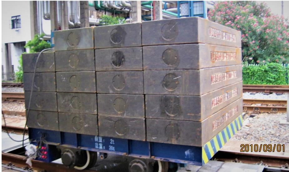
图10 采用砝码小车进行偏载性能检定
