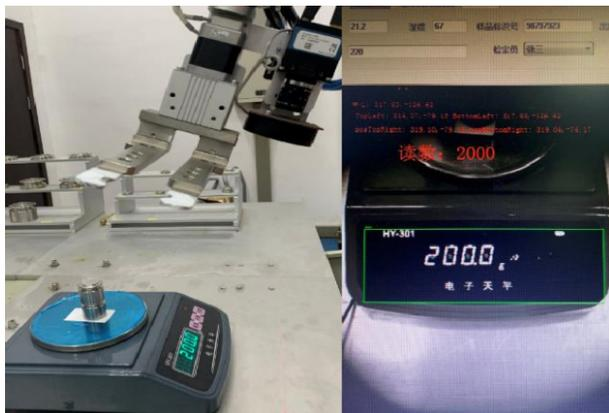
图6 用机器视觉识别数字显示屏
