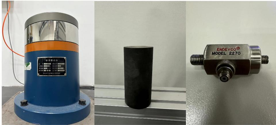
图3 标准振动台；标准质量块；标准加速度计
