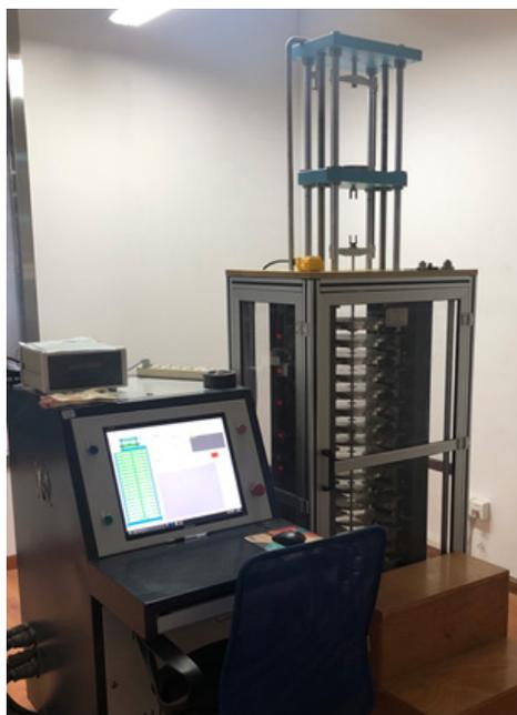
图2 1000N静重式力标准机（精度0.01级）
