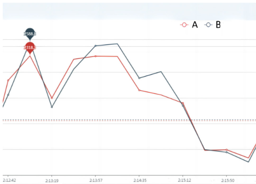
图3 A品牌称重传感器（500kg×4）与B品牌称重传感器（500kg×4）测量同比
