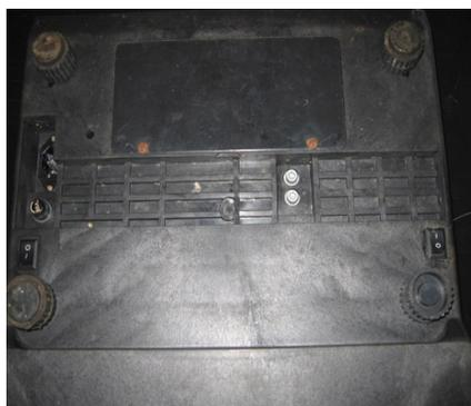
图2 秤底处作弊开关（右侧）
