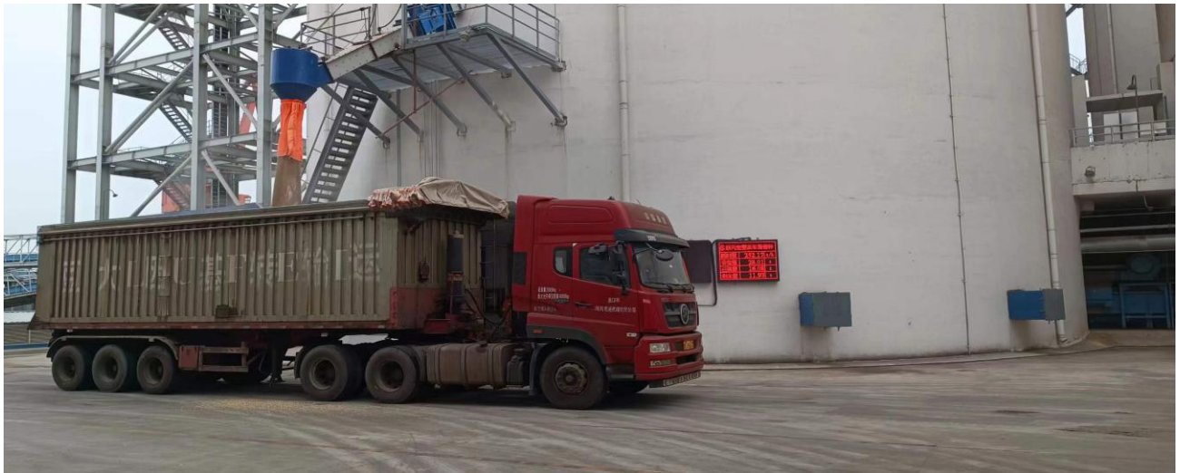
图7 散粮自动定量装车系统现场
