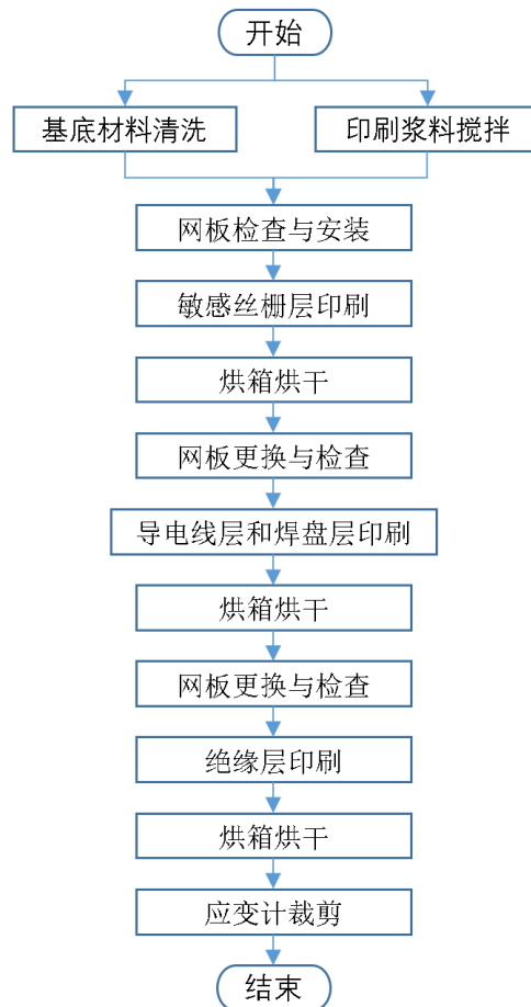
图2 碳基应变计制作工艺流程图
