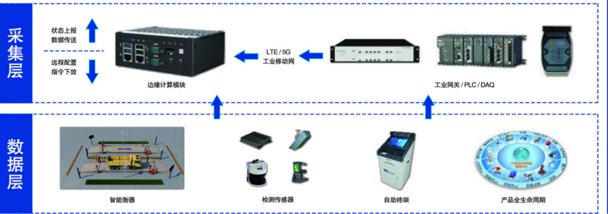
图8 汽车衡远程运维服务平台架构图
