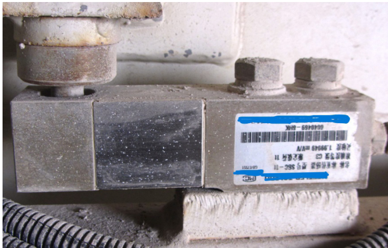
图7 悬臂梁式称重传感器安装示意图
