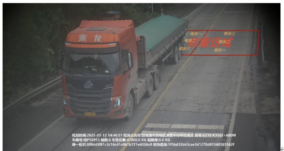
图2 三模块水泥秤台非现场治超公路中的布局
