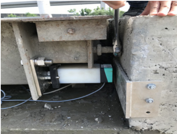
图4 位移传感器现场安装示意图
