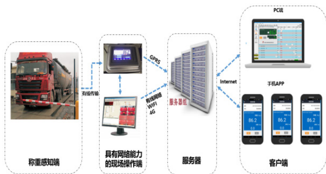
图6 实际现场静态汽车衡应用示意图
