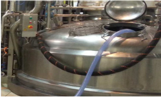
图3 水替代法校准方案示意图
