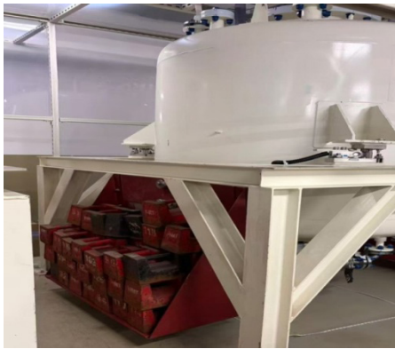
图1 砝码校准方案示意图
