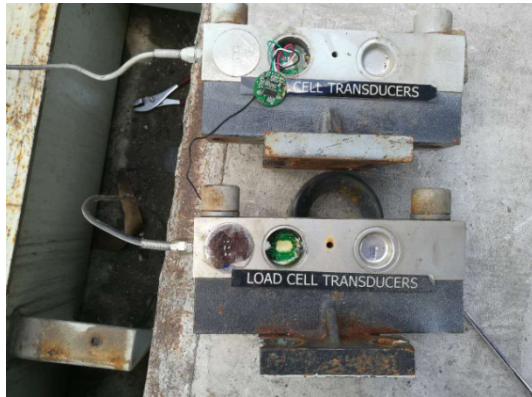
(1) 称重传感器加装接受电路形态
