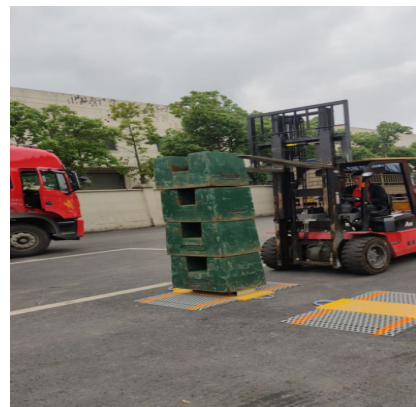
图1 砝码静态校准便携式动态轴重仪
