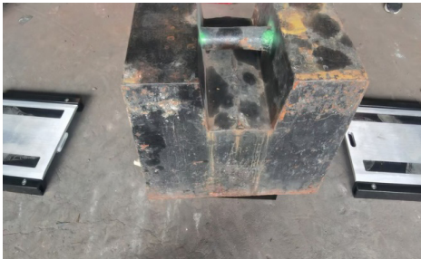
图3 砝码校准便携式汽车静态称重仪
