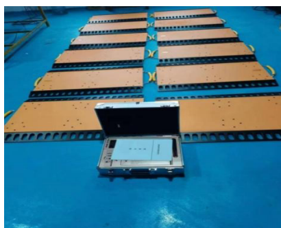
图1 便携式汽车静态称重仪实物图
