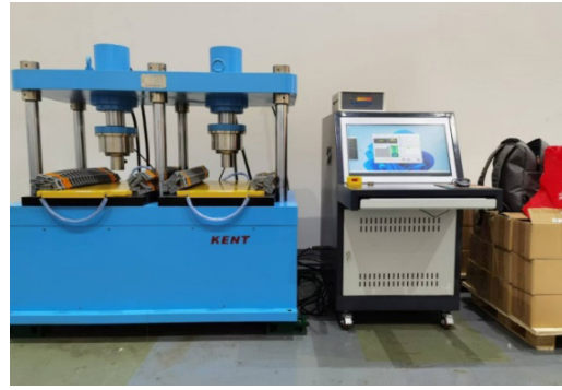
图5 便携式汽车静态称重仪校准实物图
