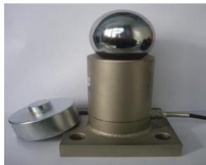
量程:10t ; 合金钢材料，涂胶密封。柱式传感器，安装使用方便灵活，抗偏载、抗侧向力强；防护等级 IP67；
